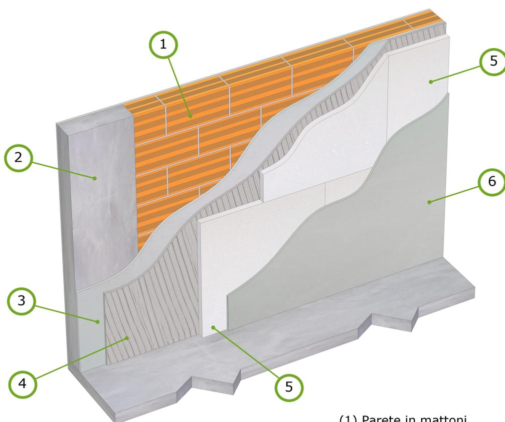
L'intonaco estremamente traspirante favorisce il trasporto dell'umidità ambientale al pannello in silicato di calcio che la trattiene e grazie al suo pH elevato impedisce la proliferazione di muffe e di batteri.
